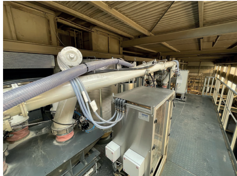
В комплект поставки TeKa также вошли взвешивающая платформа, бункеры для хранения заполнителей, весы для вяжущих материалов, фильтры для обеспыливания, шнеки для вяжущих материалов и система дозирования фибры
