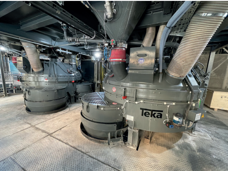
Центральным узлом новой БСУ являются два турбинных смесителя THT G-2-V от TeKa
