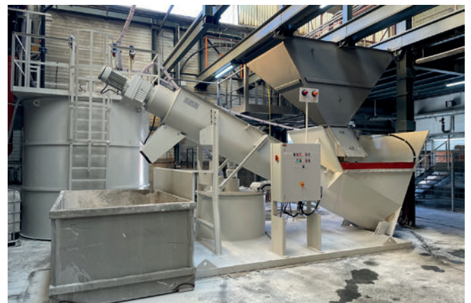
Restbetonrecyclinganlage von Wema Stahl- und Maschinenbau
