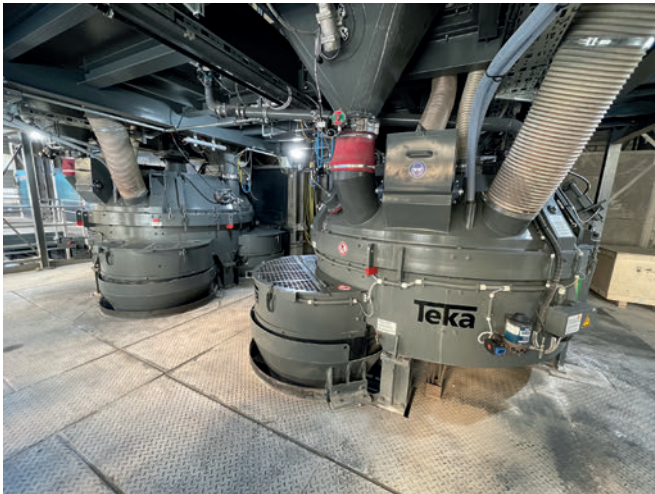
Das Herzstück der neuen Betonmischanlage bilden die beiden Turbinenmischer des Typen THT G-2-V von Teka.
