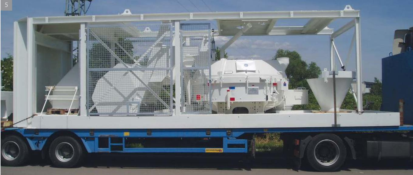
5 | Транспортировка MIXOMAT THZ 1500 B - S5, установка с радиальным складом и TEKA высокопроизводительным тарельчатым смесителем с принадлежностями.
