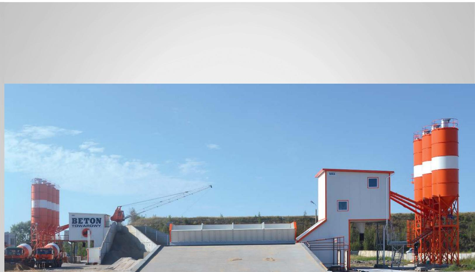
Установки для производства бетона в КОМПАКТ-исполнении
