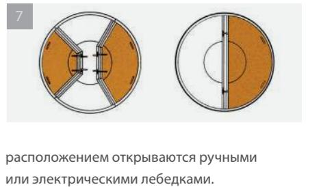
расположением открываться ручными или электрическими лебедками. Отсутствие ограничивающих пространство конструктивных элементов позволяет индивидуально размещать различные загрузочные отверстия, патрубки, вентиляционные отверстия, осмотревые люки.
