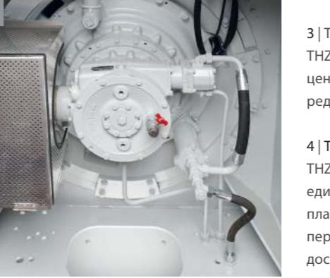
3 | Тарельчатые смесители с THZ 250 по THZ 1125 приводятся в действие единим центрально расположенным планетарным редуктором с фланцевым двигателем.
