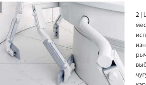
2 | Централизованная смазка втулок месильных рычагов возможна в специальном исполнении. Месильные лопатки, износостойкие манжеты для месильных рычагов и скребки стенок представлены на выбор из различных материалов: отбеленный чугун W4, сталь с полным покрытием из карбida хрома, полиуретановый эластомер (PU), безникелевое литье и т. д.
