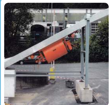
Drehkübel 3.500 l in Steigung 32° = 60%
