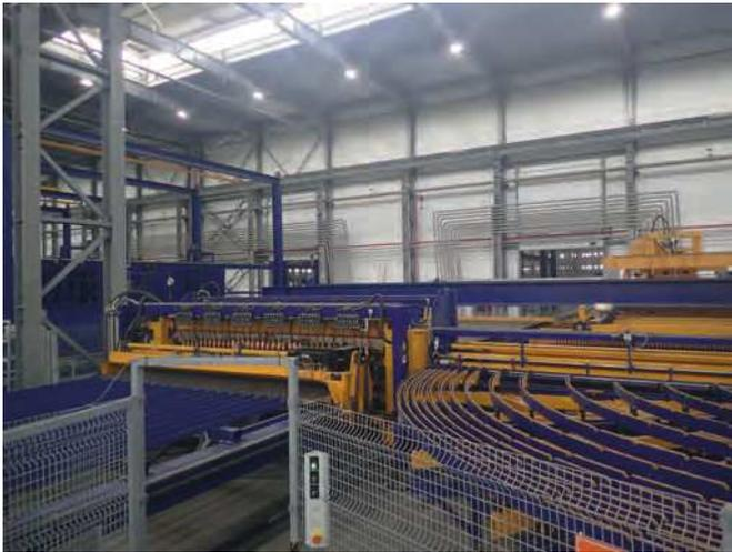
Gitterschweißmaschine Typ HFBE/158
