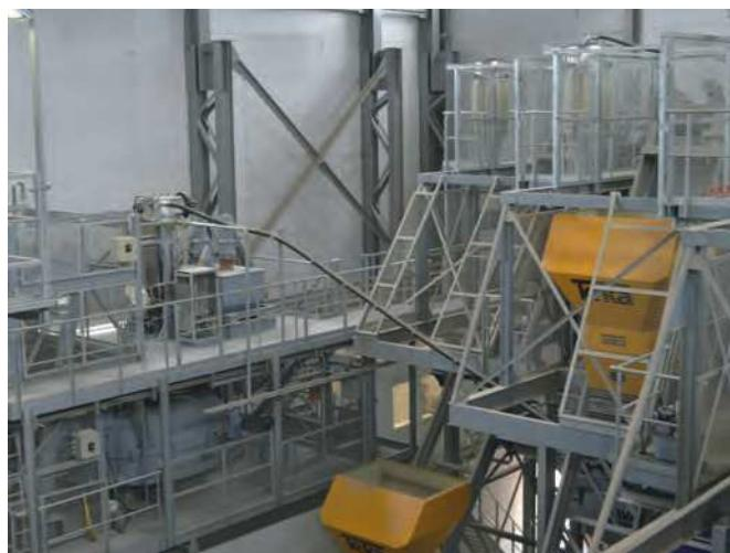
Die gesamte Betonmischanlage setzt sich zusammen aus fünf nebeneinander stehenden und komplett eigenständigen und unabhängigen Mischstationen.
