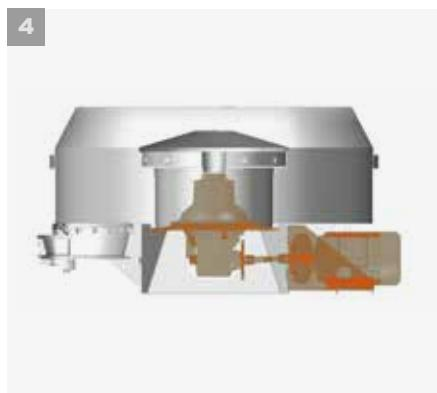
**5** | La unidad de compuerta de descarga está fijada, como componente completo, al fondo de la cuba de mezclado. La compuerta de descarga semicircular se acciona hidráulicamente mediante un cilindro de pistón rotatorio que está protegido mediante un anillo de fundición. El grado de apertura deseado se controla eléctricamente. Dos interruptores de final de carrera exentos de desgaste garantizan cualquier posición de la compuerta.
