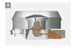
Die am Getriebe angeflanschte Ölpumpe sorgt für die Ölumwälzung und für die Betätigung der Entleerung. Durch den gemeinsamen Ölhaushalt ist nur geringer Wartungsaufwand für Getriebe und Entleerung erforderlich.
